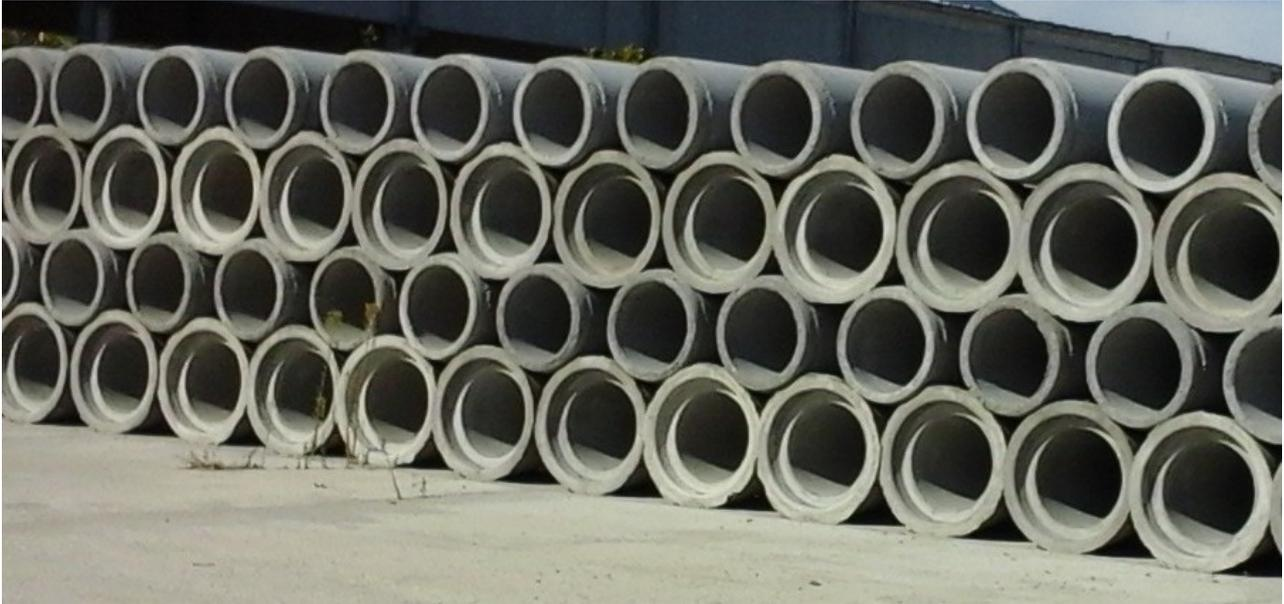
Immagini di tubi  $\varnothing$  int. 50 e 60 cm in magazzino ed in produzione
